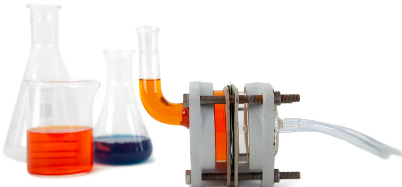
Célula de prueba para permeabilización química (montada)
