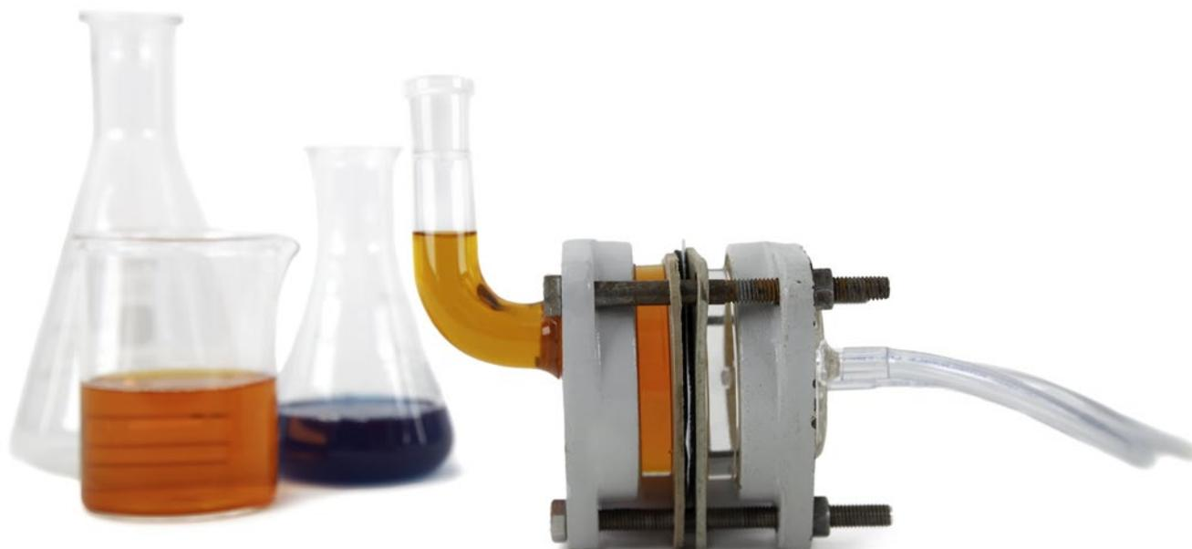
*Cella di prova di permeazione chimica (assemblata)*
